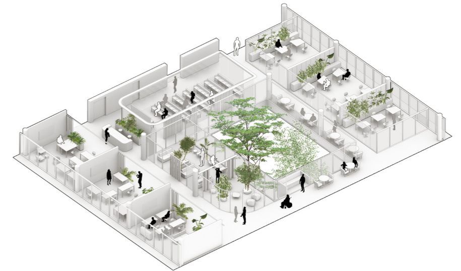
ISOLA FUNZIONALE - SCENARIO TIPO 2 Il ricorso alla modularità e l'utilizzo alternato di partizioni interne vetrate e opache mobili, uniformemente distribuite ai piani, permette uno spettro di soluzioni spaziali, quantitative, connettive e funzionali variegato, consentendo di poter organizzare lo spazio secondo configurazioni più aperte ed integrate, adattabili a condizioni d'uso differenziate presenti e future senza escludere soluzioni di lavoro più tradizionali, garantendo diversi livelli di organizzazione del lavoro, individuale o di team e l'utilizzo degli spazi con modalità dinamiche e di condivisione che favoriscono socializzazione e collaborazione tra gli utenti.
